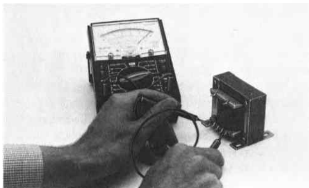
Bild 4.33: Durchgangsprüfung an einem Transformator.
